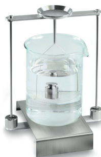
Uniwersalny zestaw do oznaczania gęstości KERN YDB-03
